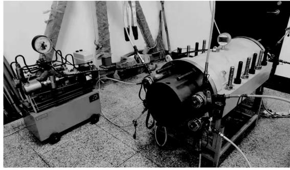
图 9 试压泵打压测试管卡密封压力过程
