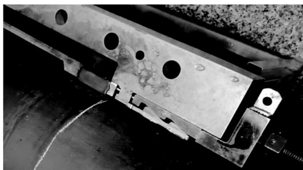
图12 密封件接触处的泄漏痕迹
