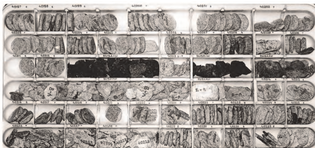
图5 科拉超深井万米以上井段的岩心
