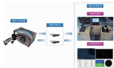
图3 上海交通大学的“驾驶舱+地面站”SPO组合方案演示和验证系统架构 [9]
