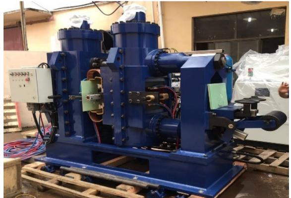
图 10 郭晋龙科研团队研发的固定式钢轨焊接机(郭晋龙提供)
