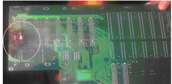
图4 烧毁的工控机主板（郭晋龙提供）
