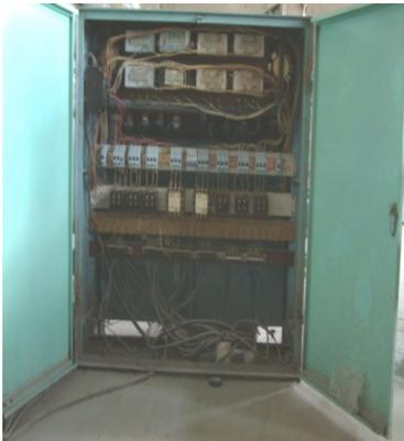
图 6 钢轨胶接绝缘接头生产设备内部(郭晋龙提供)
