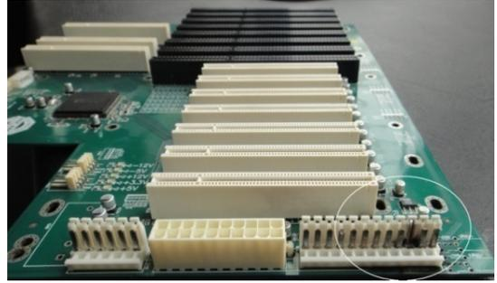
图3 烧毁的工控机底板（郭晋龙提供）
