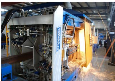
图1 GAAS80/580钢轨焊机(郭晋龙提供)
