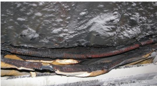
图2 车体箱壁内烧毁的电路（郭晋龙提供）
