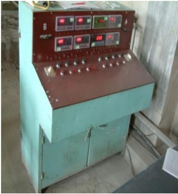
图 5 钢轨胶接绝缘接头生产设备电气控制柜外观
