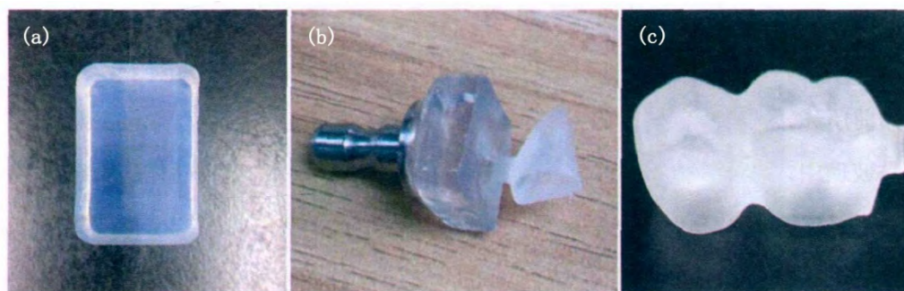
图 9 硅酸锂微晶玻璃光学照片 [67] : (a) 切削前的硅酸锂微晶玻璃; (b) CAD/CAM 切削的硅酸锂微晶玻璃单冠; (c) CAD/CAM 切削的硅酸锂微晶玻璃二元桥牙冠
