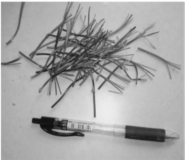
图 3 直剪试验人造根系
