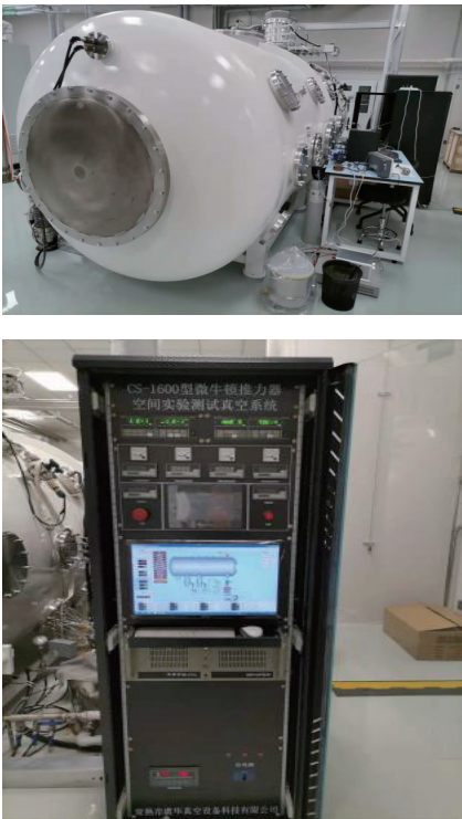
图 2 CS-1 600 微牛级电推进实验平台 Fig. 2 The CS-1 600 micro Hall electric propulsion experimental platform
