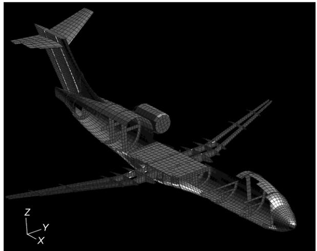
图10 飞机内部结构有限元模型
