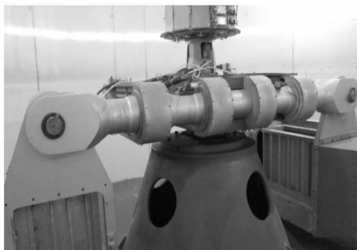
图1 TLJ-3型离心模型试验系统
