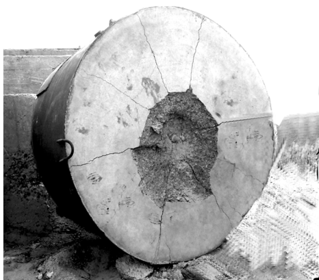
图 4 速度为 530 m/s 的模拟弹撞击靶正面
