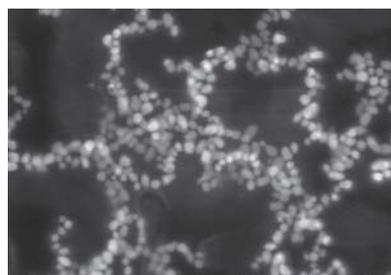
图1 胶体金溶液的透射电镜观察图像
