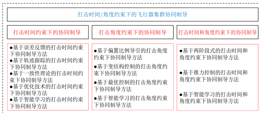
图 2 终端时空约束下的飞行器集群协同制导方法
