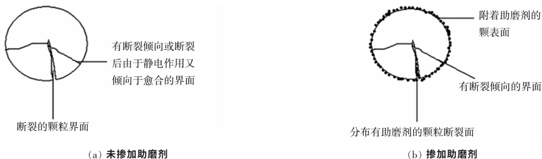
图13 助磨剂在水泥颗粒表面和断裂面的吸附
