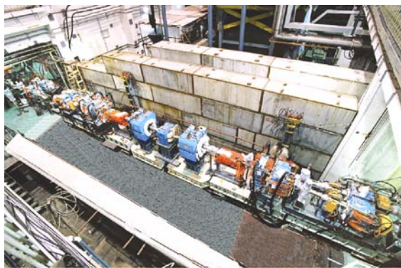
图7 采用常规磁铁的对撞区,北京谱仪的安装和超导磁铁的联合测磁就在屏蔽墙外进行
