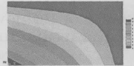
图8 缸动式 10mm 坯体厚度分布云图
