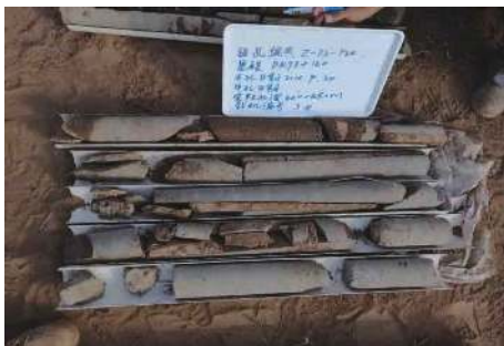
图 6 钻孔 Z-73-120 深度 40~45 m 岩芯 (岩芯被张裂缝一分为二, 泥质充填)
