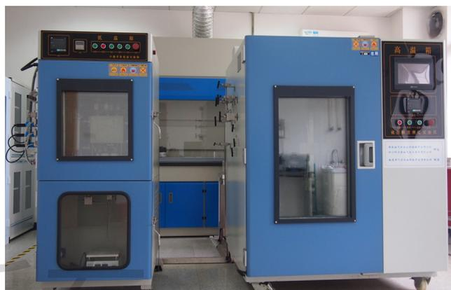
图1 元素硫溶解度测定装置实物照片
