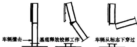
图6 双柱解体消能原理
