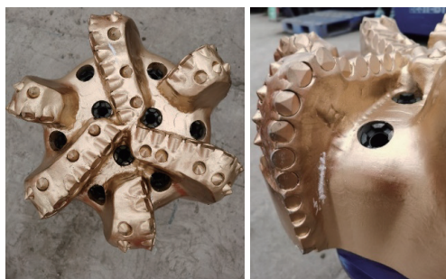
图2 AX616型PDC钻头冠部结构
