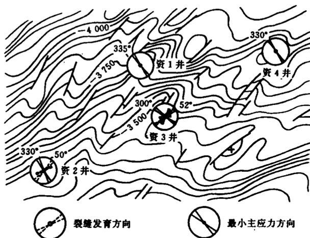
图4 资阳地区现代构造应力与裂缝走向关系图
