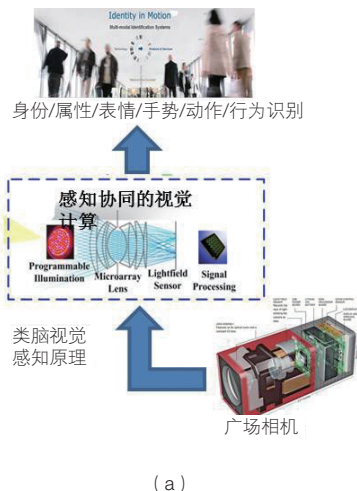
图6 三维光场相机及其原理示意图(a)和主动仿生双眼视觉系统(b)
