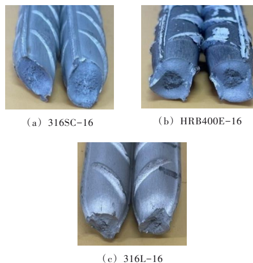
图 6 不同钢筋宏观断口形貌对比
