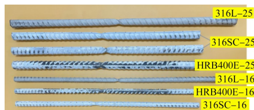
图 5 不同钢筋颈缩现象和伸长量对比
