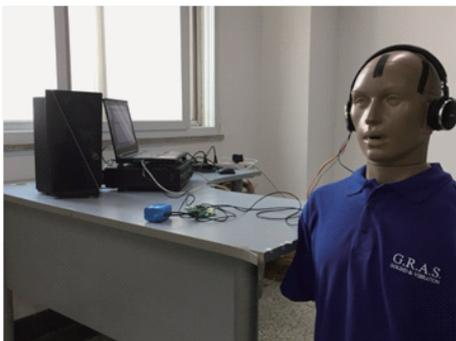
图3 基于DSP的ANC耳机测试实物图
