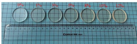
图7 LiME掺量为0%~12%、样品尺寸为ø33 mm×6 mm的块体塑料闪烁体样品
