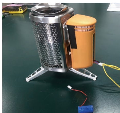
图7 一种商业化的便携式温差发电炉
