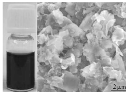
b 氧化石墨片分散在 DMF 中及相应 SEM 图像
