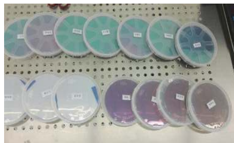
图2 学生实验硅片,硅片不同颜色表明处于不同实验阶段
