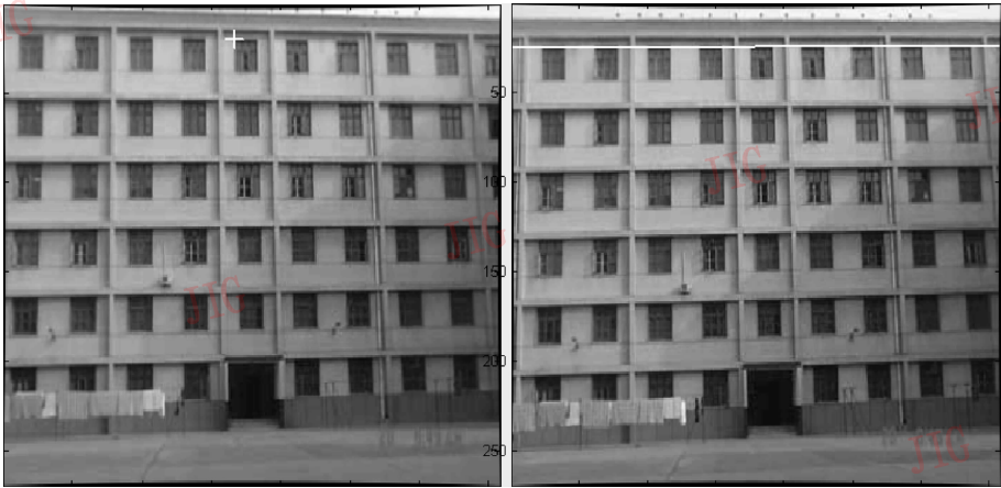
图 3 本文提供方法畸变校正后的图像 Fig.3 The rectified images using the new approach
