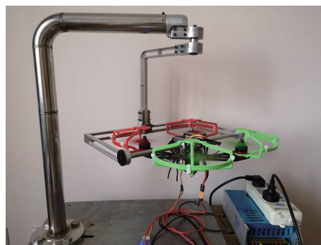
图8 四旋翼飞行器姿态控制自制教学设备的实际运行
