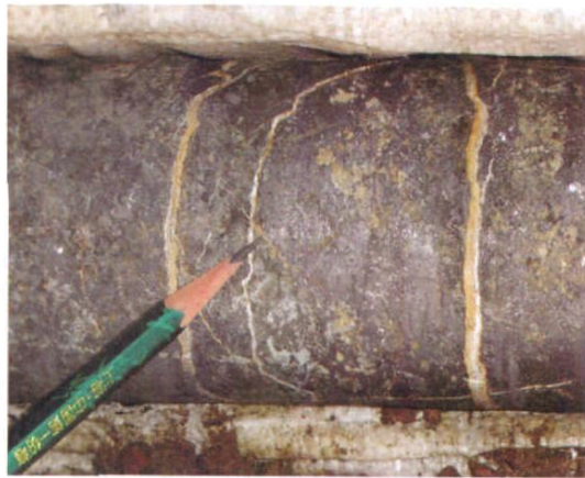
图 7 ZK0602 钻孔中块状富钒钛磁铁矿
