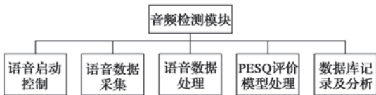
图 5 音频检测模块功能框图 Fig. 5 Block diagram of sound test module
