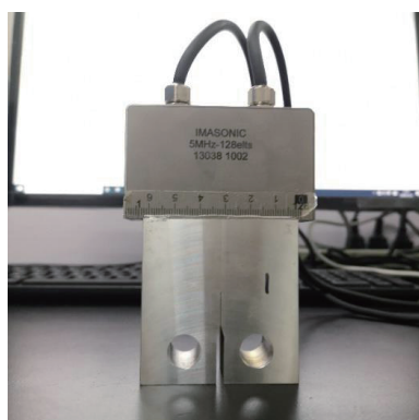
图1 相控阵探头和 7075Al CT 试样照片
