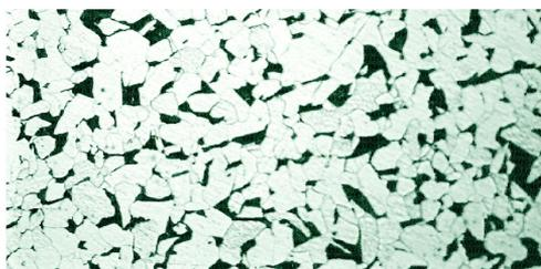
图3 1<sup>#</sup>弯管重新正火后组织(×200)
