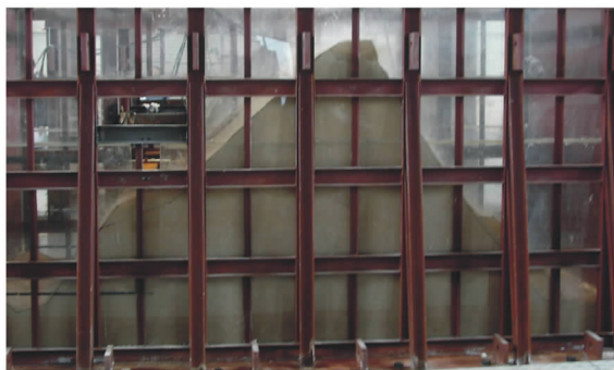
图 1 双面高陡边坡的振动台试验模型
