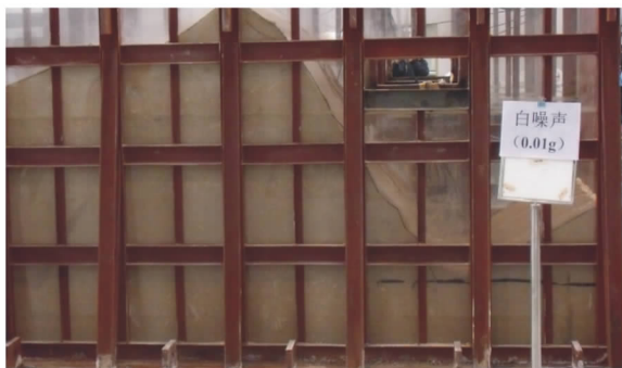
图 2 单面高陡边坡的振动台试验模型
