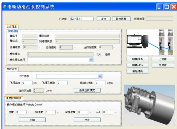
图3 电驱动滑油泵上位控制界面
