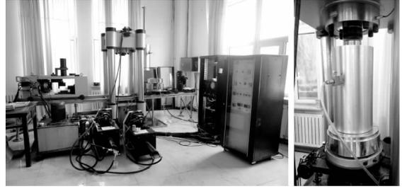
图 1 TAW-2000 电液伺服岩石三轴试验机
