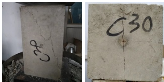
(a)混凝土轴心受压试验 (b)混凝土劈裂抗拉试验
