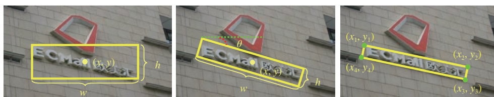
图 1 (网络版彩图) 包围盒的不同表示方式
