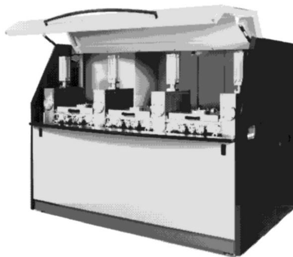
图 2 真空回流焊接设备 Fig. 2 Vacuum reflow soldering system
