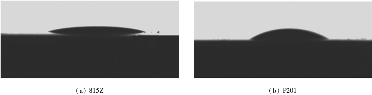
Fig. 4 Images of lubricant droplets sitting on the surface of WS 2 film 图 4 润滑剂在 WS 2 薄膜表面的接触角照片
