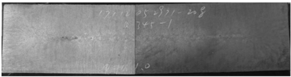
图3 200 mm×850 mm低倍组织 Fig.3 200 mm×850 mm macrostructure
