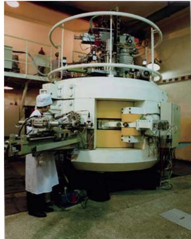
图2 30 MeV强流质子回旋加速器
