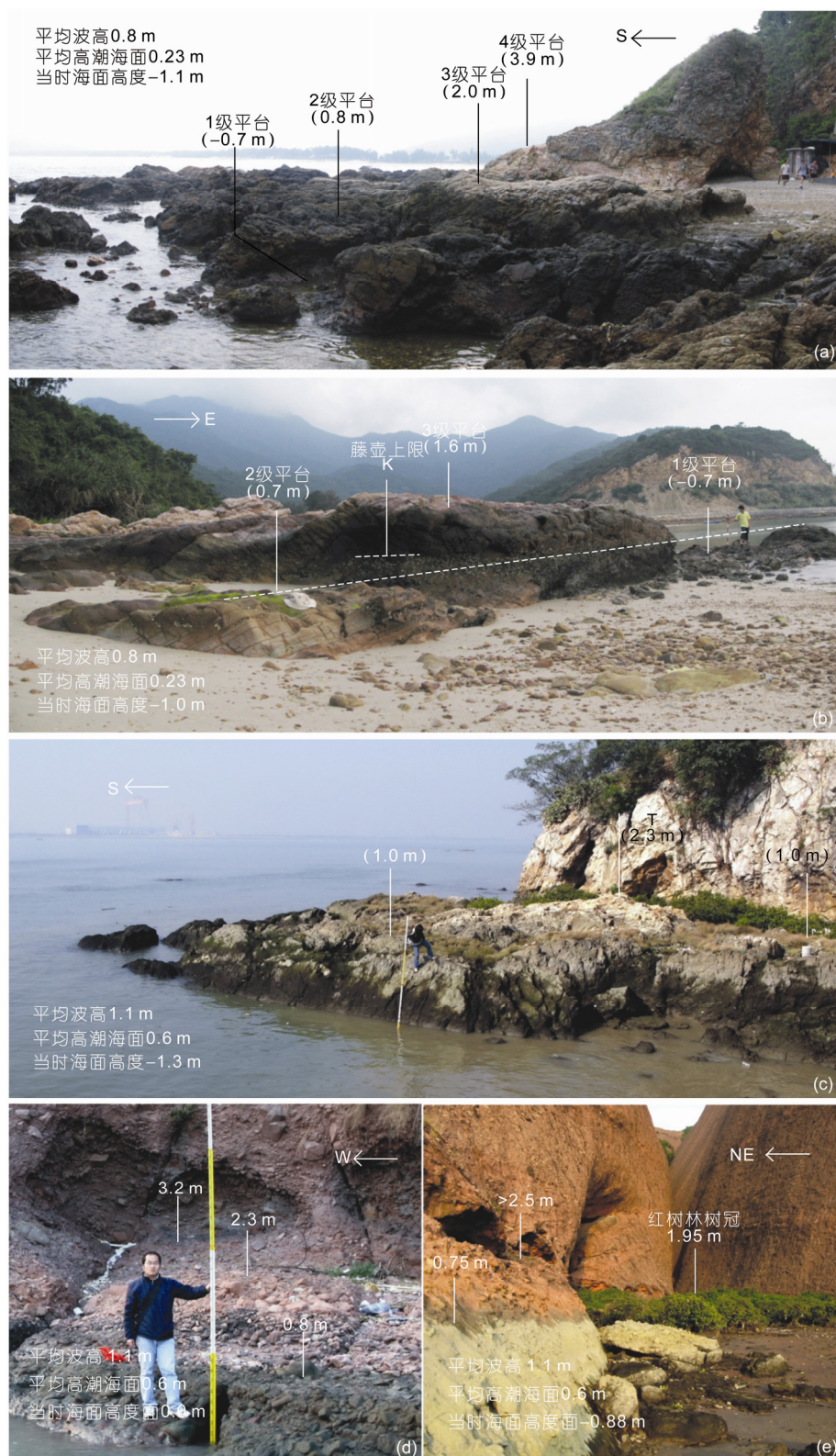
图3 珠江口内外现代海蚀平台实测高度(珠基) (a) 西冲湾; (b) 杨梅坑; (c) 舢板洲; (d)和(e) 大虎岛
