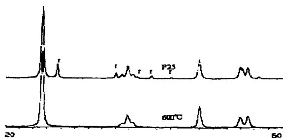
图 8 600℃处理制得的 TiO 2 和商品 P25 的 XRD 图
