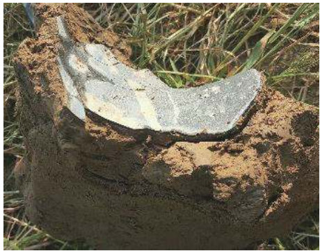
图 11 开挖过程中脱落的水泥固结体
