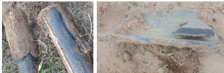
图 14 钢管桩拔出时桩周形成的水泥固结体
