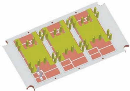
图 12 非柔性 PCB 平面封装功率模块结构设计图 Fig. 12 Structure design of an inflexible PCB packaged planar power module
