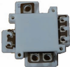
图 10 柔性 PCB 平面互连功率模块样品 Fig. 10 Prototype of planar packaging power module with flexible PCB
