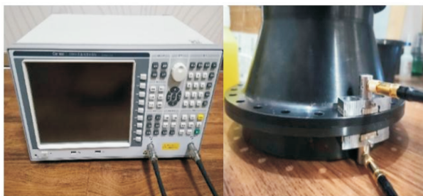
图2 转子界面连接刚度测试系统
