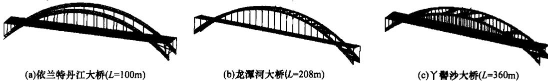
图1 大跨度中承式钢管混凝土拱桥空间有限元模型
