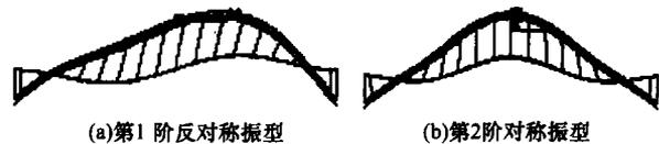
图2 大跨度钢管混凝土拱桥面内振动振型
