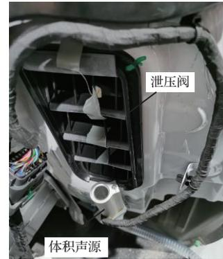
图7 静置试验示意图
