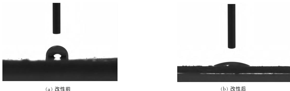
图7 改性前、后胶粉与水的接触角
